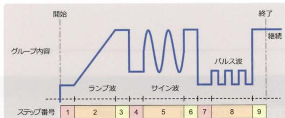
また、シーケンス動作中に任意の条件(電圧・電流・時間)になった際に別のプログラムに移行することが可能な「条件分岐機能」もっており、複雑な放電シミュレーションプログラムを構築することが可能です。
